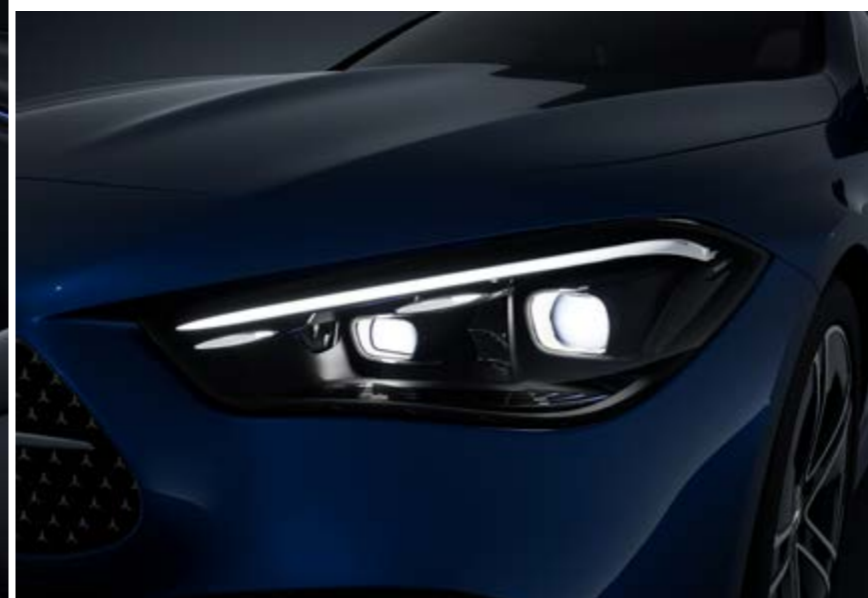
DIGITAL LIGHT mit Projektionsfunktion (PAX) und Adaptiver Fernlicht-Assistent Plus (628)
