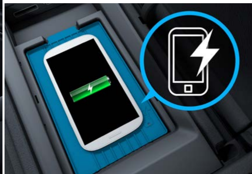
Kabelloses Ladesystem für mobile Endgeräte vorn (897)
